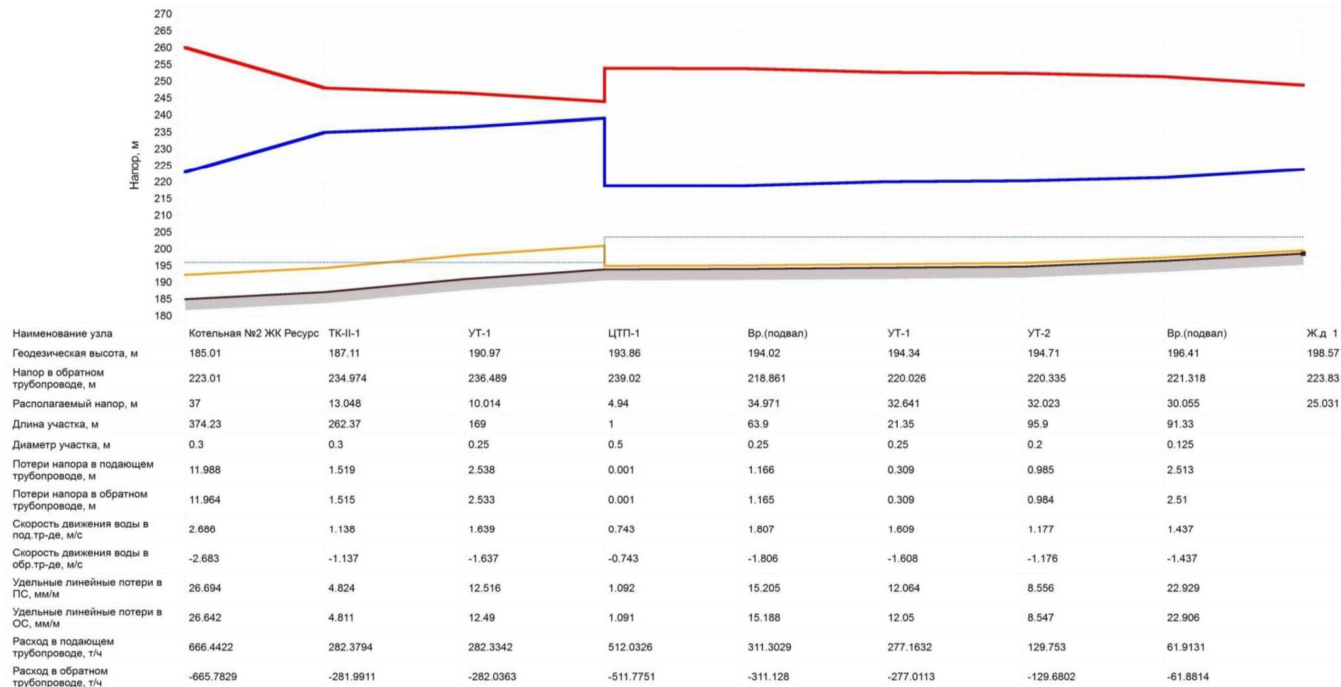
Рисунок 1.100- Пьезометрический график вдоль расчетного пути «котельная №2 ООО «ЖК-Ресурс» – ж/д №1»
