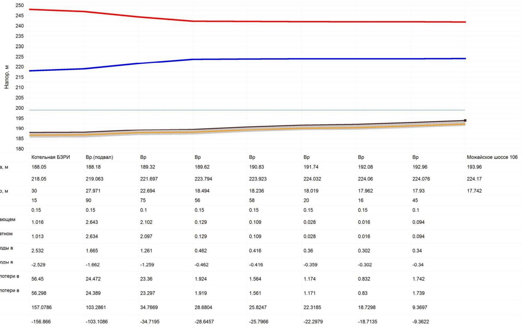
Рисунок 1.95- Пьезометрический график вдоль расчетного пути «котельная ООО «БЗРИ» – Можайское ш., 106»
